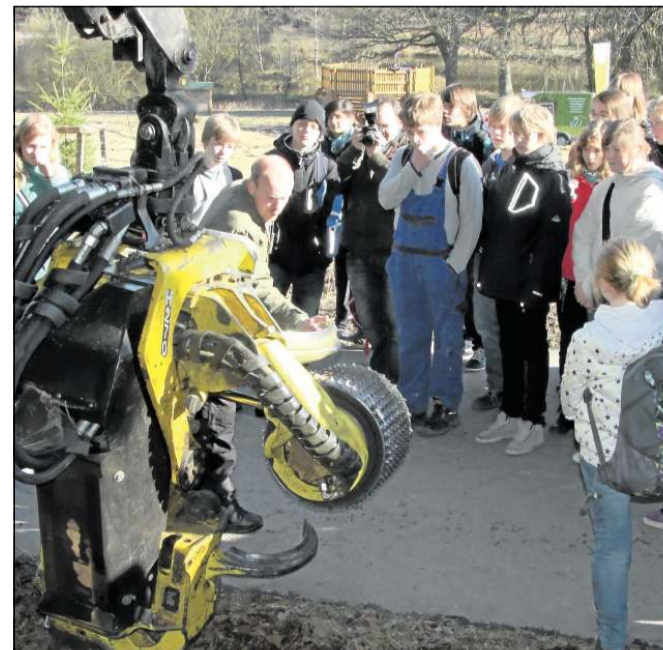
Zerlegt in Sekunden ganze Bäume: Förster Thomas Busche erklärte die Funktion des Harvester-Kopfes.
